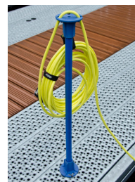
Oppkveilet elkabel festes i opphengstropp, klar til bruk.
